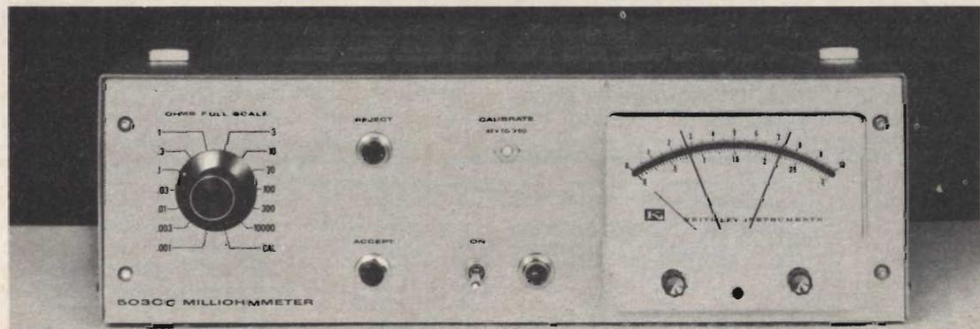
In ogni caso il campione in prova non è mai soggetto ad una potenza superiore a  $10 \mu W$ , il che garantisce l'integrità dei materiali anche più sottili.
